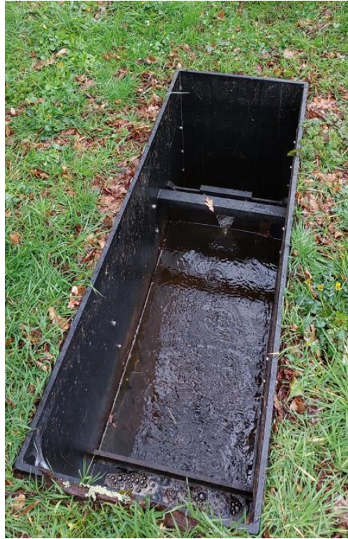
Figure 12 : canal de comptage
