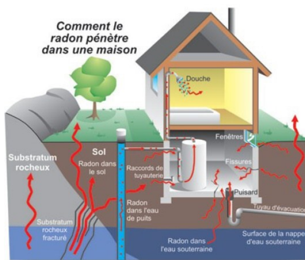
Propagation du radon dans une habitation
